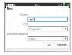
Schließt man das Fenster, so kommt man in den Editiermodus. Alle Programmierbefehle werden zeilenweise in den Bereich zwischen *Prgm* und *EndPrgm* eingefügt, wo sich jetzt das gestrichelte Rechteck befindet. Jeder Befehl kommt in eine neue Zeile, Leerzeilen werden später bei der Ausführung des Programmes ignoriert.
