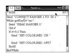
Es fehlt noch die Warntonfolge. Im Menü Send"SET befindet sich unter der Bezeichnung SOUND der eingebaute kleine und recht leise Lautsprecher. Der Befehl muss noch vervollständigt werden durch die Frequenz des zu hörenden Tones in Hz.
